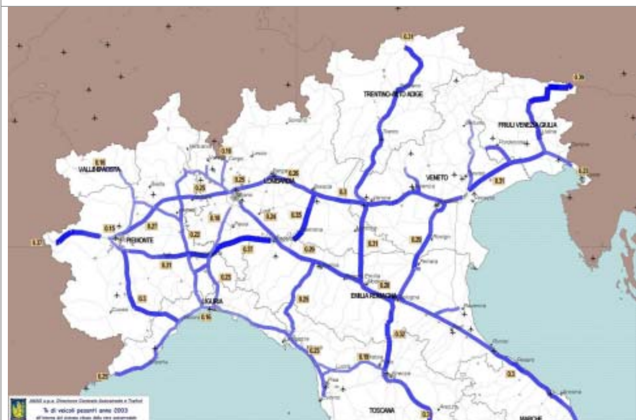
Figura 11: percentuale di veicoli pesanti anno 2003 sulla rete autostradale (dati forniti dalle società concessionarie)
